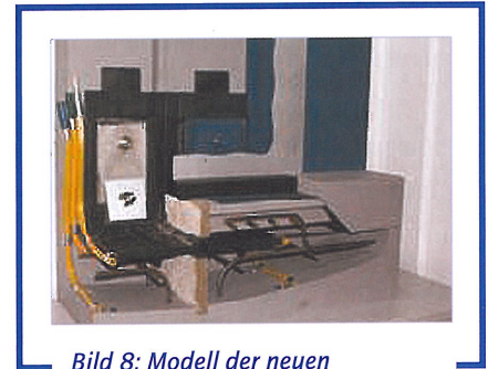
Bild 8: Modell der neuen Fugenabdichtung im Übergang Sohle/Wand
